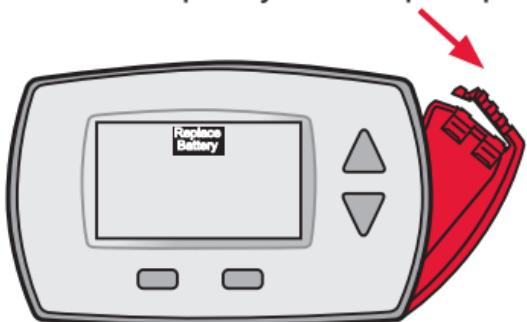
Inserte dos baterías nuevas AA alcalinas, luego, vuelva a instalar el soporte de la batería.
